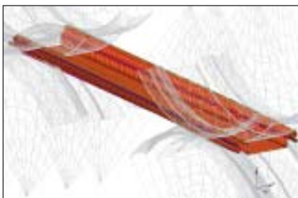
Das fertige Profil links und die mit COPRA FEA RF ermittelte Deformation (rechts)
