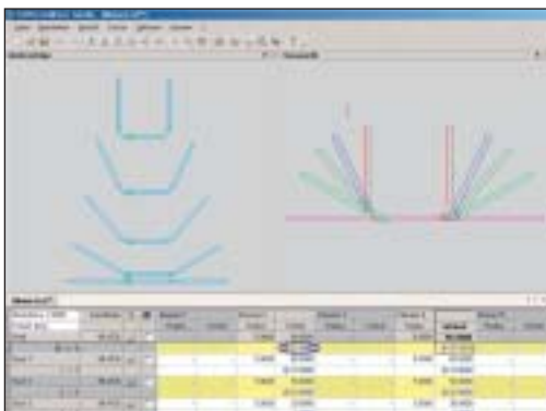
COPRA® »Spreadsheet« ermöglicht es, die Biegewinkel relativ zu ändern
