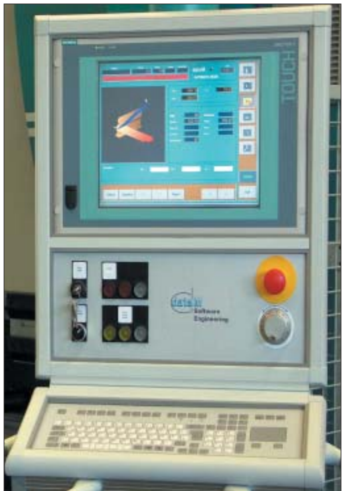
Beim Anbiegen des Teiles wird die reale Blechdicke ermittelt
