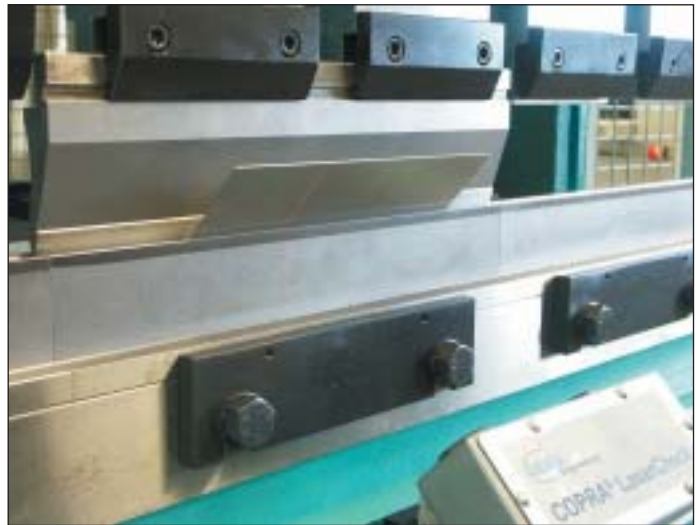
Beim Anbiegen des Teiles wird die reale Blechdicke ermittelt
